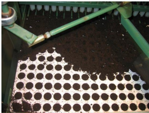
Figure 11 : Remplissage des alvéoles (terreau)
