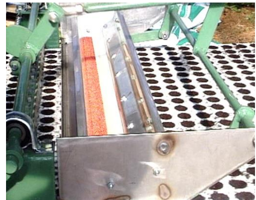
Figure 12 : Remplissage des alvéoles (graines)
