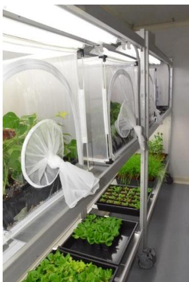
Les salles climatiques constituent des équipements indispensables notamment pour l'élevage d'arthropodes. Ces salles sont des enceintes où l'on contrôle la température, la durée et l'intensité lumineuse ainsi que l'humidité de l'air.
