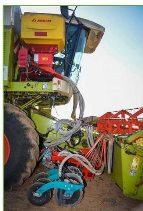
Installation du semoir derrière la barre de coupe.
